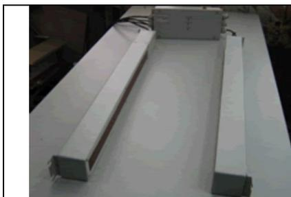
Датчик контроля отверстий ДКО-2 предназначен для обнаружения контрольных отверстий на движущейся полосе, непрозрачной для инфракрасного излучения.
